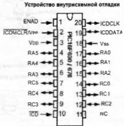
Рис. 9.2. Микросхема эмуляции для 14-выводных микроконтроллеров PIC
