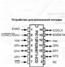
Рис. 9.1. Пробник ICD2 для восьмивыводных микроконтроллеров PIC
